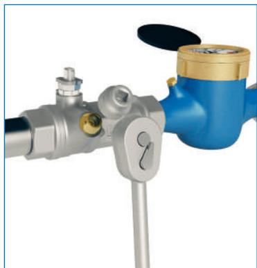
A valvola chiusa, agire tramite la chiave antimanomissione a profilo triangolare (Art. 6805000000), svitare il limitatore di portata e sostituirlo con uno di differente classe di portata.
